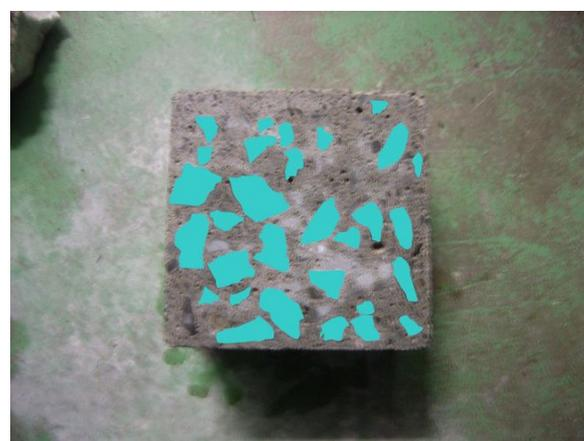
写真-1 画像処理後の角柱供試体断面
