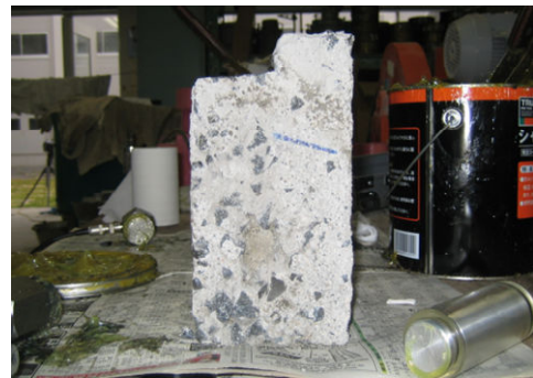
写真-1 30mm削った後の供試体
