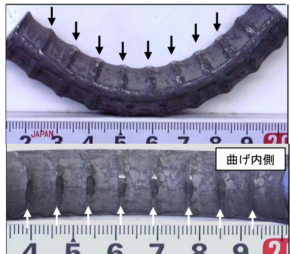
写真-5 2.5d 曲げ加工後の外観写真
