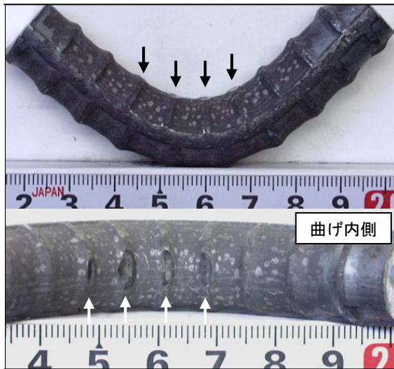
写真-2 1.0d 曲げ加工後の外観写真
