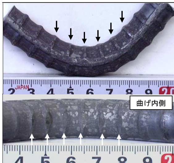
写真-3 1.5d 曲げ加工後の外観写真
