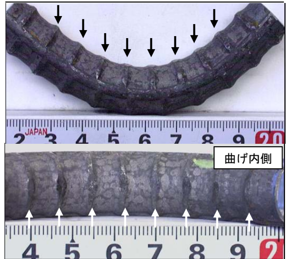
写真-4 1.9d 曲げ加工後の外観写真
