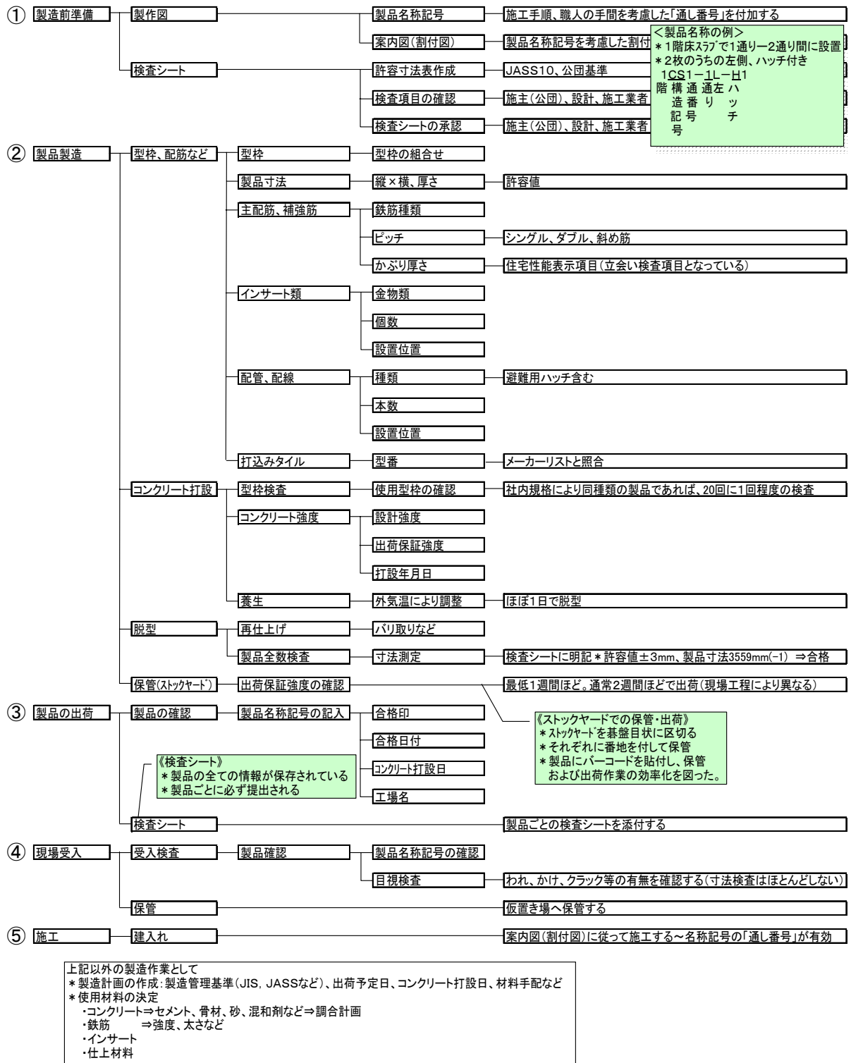
図-1 PCa 部材の検査項目
