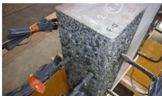
写真-2 粗面仕上げ状況 (P-3)
