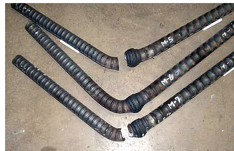
写真-4 異鋼種異径継手の曲げ試験結果例(継手M)
