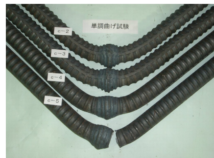
写真-2 同鋼主同径継手の曲げ試験結果例(継手M)
