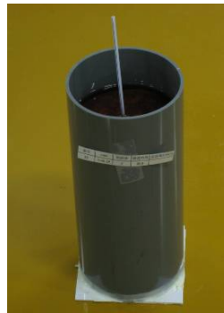
写真 - 1 浸透中の供試体
