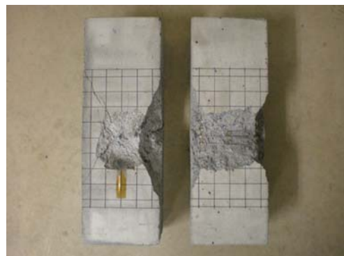
写真-3 無筋コンクリート柱と鉄筋コンクリート柱の損傷状況
