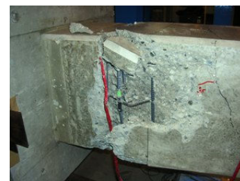
写真-3 無補強 (C-C 断面付近での破壊)
