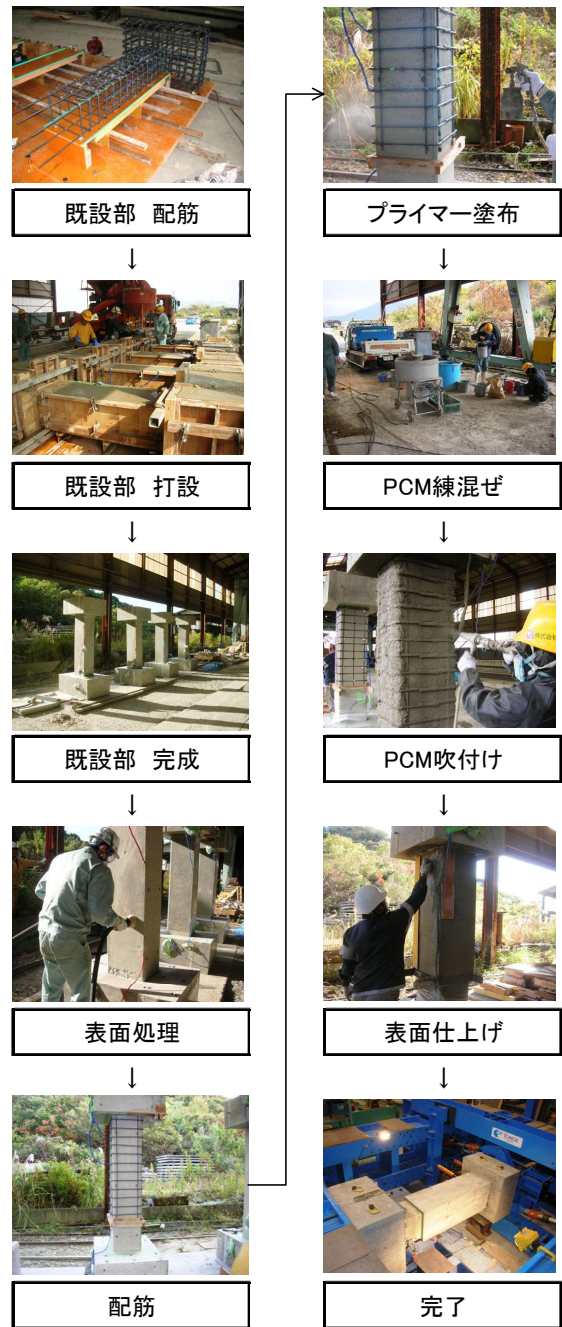
写真-1 供試体の作成フロー
