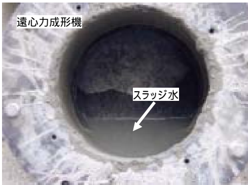
写真 - 1 遠心力成形機およびスラッジ発生状況
