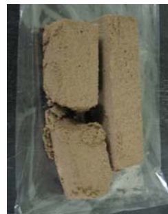
写真-3 SHL65 (1000 ^{\circ}\text{C} ) 供試体の外観
