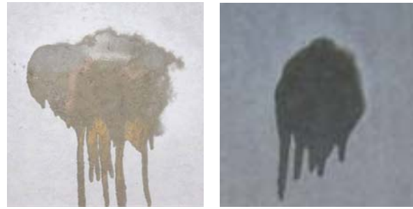
(a) 塗布箇所 (b) 未塗布箇所 写真-5 水の噴霧による吸水防止状況
