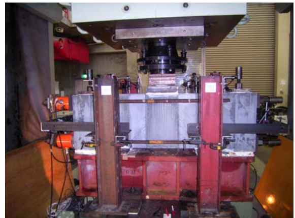
写真-2 せん断実験 荷重状況
