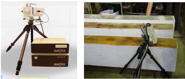
写真-3 ポータブル型蛍光X線分析装置(左)及び本装置による測定状況(右)
