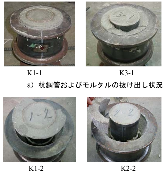
写真-1 供試体底面の破壊状況例
