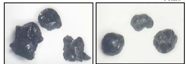
磨砕前 磨砕後 写真-1 石炭溶融スラグの顕微鏡写真
