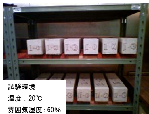
写真 - 3 乾燥収縮試験状況
