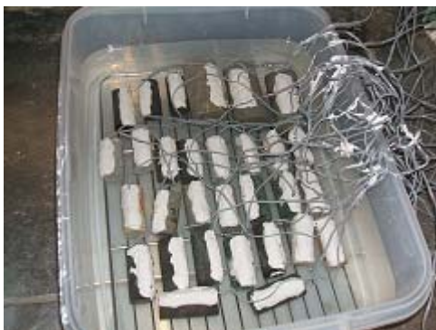
写真 - 1 乾燥収縮特性試験状況
