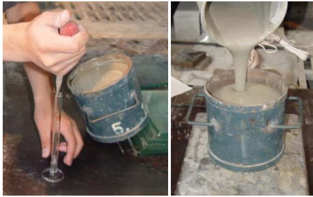
写真-3 プリーディング試験の状況
