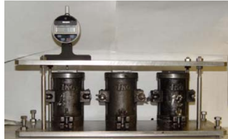
写真-4 収縮試験の状況
