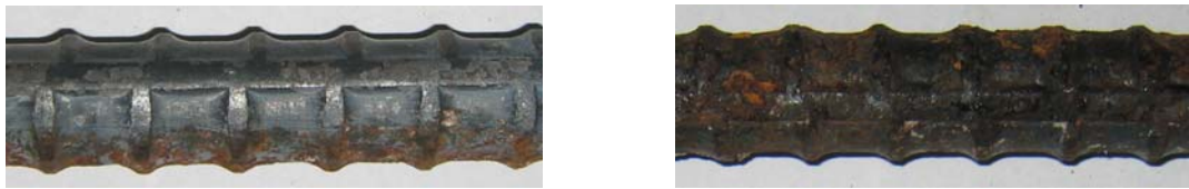
(a) 全塩化物イオン濃度 1.4% (4.0kg/m 3 ) (b) 全塩化物イオン濃度 2.7% (8.0kg/m 3 )
