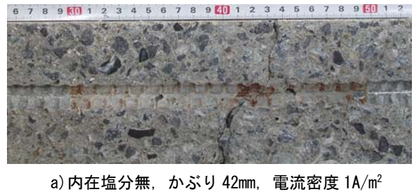
図-11 内在塩分無, かぶり 42mm, 電流密度 1A/m 2 , 初期ひび割れ有の電食後の試験体状況
