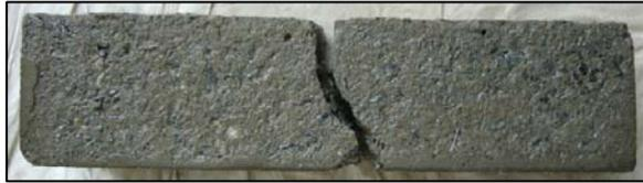
b) 割裂状況 (側面) (B2 供試体 : 198 サイクル)
