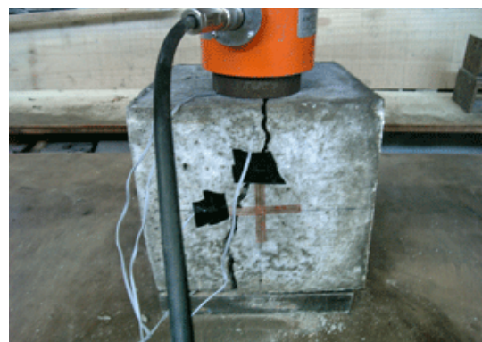
写真-6 圧縮実験におけるひび割れ状況
