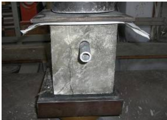
写真-4 圧縮载荷実験における破壊状況例
