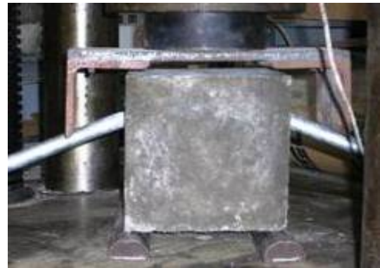
写真-5 曲げ実験の状況
