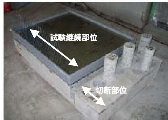
写真 - 2 コアリング、切断後の状況
