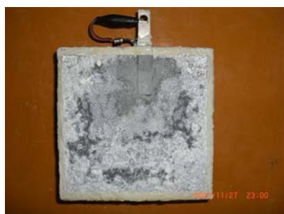
(「Z」40°C乾湿繰り返し：白い変色部分が溶射膜の浮き)
