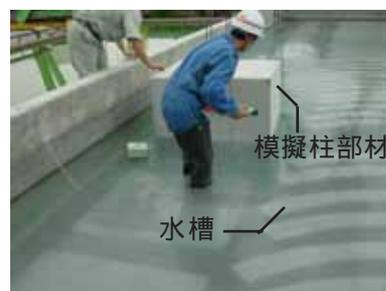
写真 - 1 模擬柱部材初期水中浸せき風景
