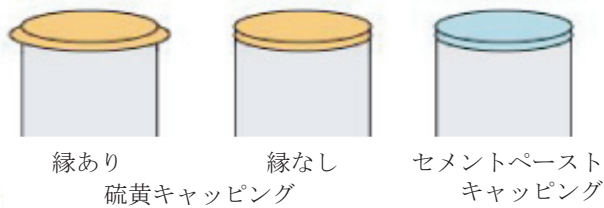
図-1 試験体の端面処理方法
