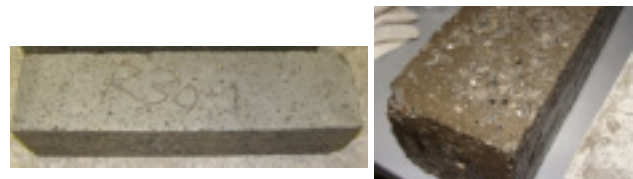
写真-1 160 サイクル終了時点での配合 RF30 の供試体
