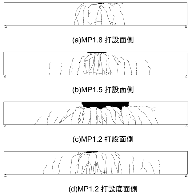
図-5 ひび割れ状況(長期曝露試験体)
