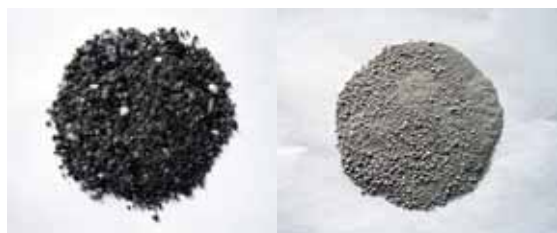
写真 - 1 一般ゴミ焼却 写真 - 2 建設汚泥固化物 融灰溶融スラグ
