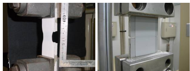
静的ひび割れ追従性試験
