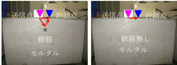
(a) 有筋試験体 (b) 無筋試験体 図-3 試験体への送受信アンテナの設置概要
