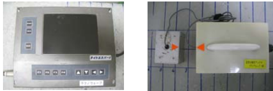
装置本体 送受信アンテナ 図-2 電磁波レーダ装置
