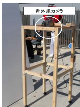
写真-1 赤外線カメラによる測定状況
