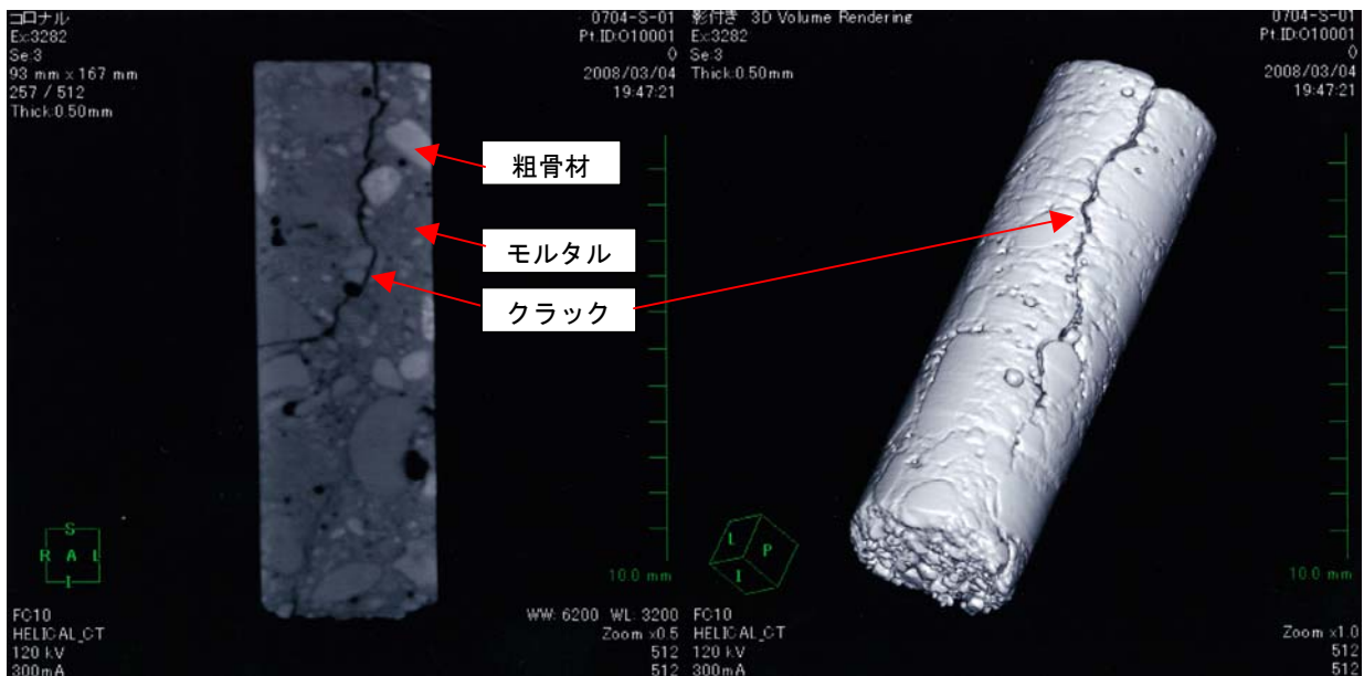
図 - 1 X線CT法によるコンクリート・コアの断面画像（昭和36年施工，構造体コンクリート）
