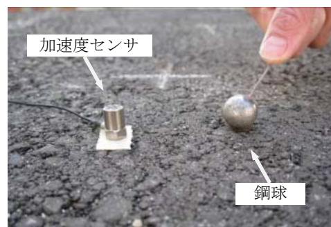
写真-3 衝撃弾性波法の計測状況
