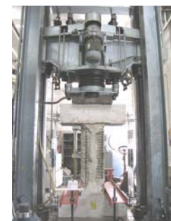
図-6 軸力载荷状況
