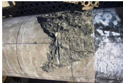
写真-2 CFS 外側のかぶり剥落 (D4F10P22L2T1FC)
