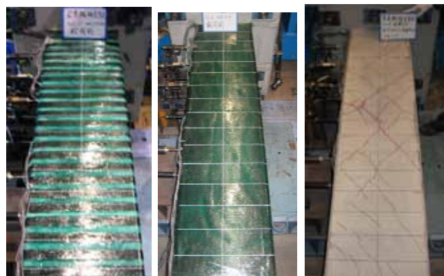
図 - 2 CFRP 補強後供試体 (左: No.1, 中: No.2) と補修前のひび割れ発生状況 (右: No.3)
