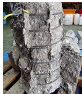
写真-1 円柱部材の破砕状況
