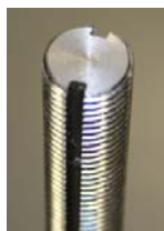
写真-3 切削したアンカー筋
