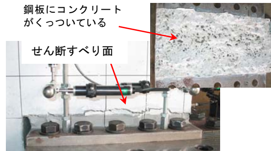
写真-3 最終破壊状況（試験体 S09-25）
