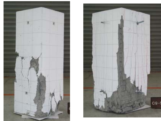
試験体 C9-0 (増打ちなし) 試験体 C9-5-4 (50mm) 写真-1 最終破壊状況 (中心圧縮実験)
