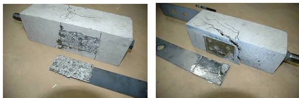
写真-1 スパイラル筋あり試験結果 ( f_c=36.9\text{N/mm}^2 )
