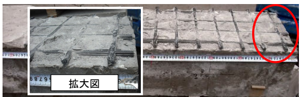
写真-3 ひび割れ性状
