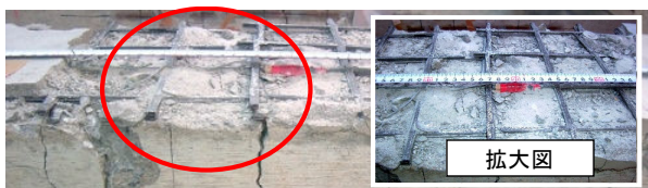
(a) FRP グリッド付着破壊 (Type2)
