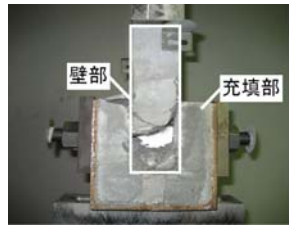
写真-6 壁部引張破壊 UFC充填の場合
