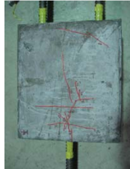
写真-2 A-T2破壊性状(左: 千鳥 右: ダブル)
