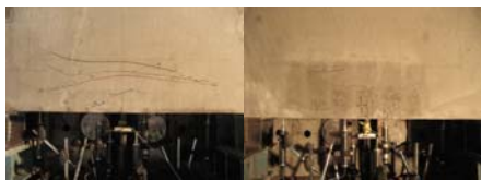
頭ナット有り 頭ナット無し (b) 鉄筋が引張降伏したもの
