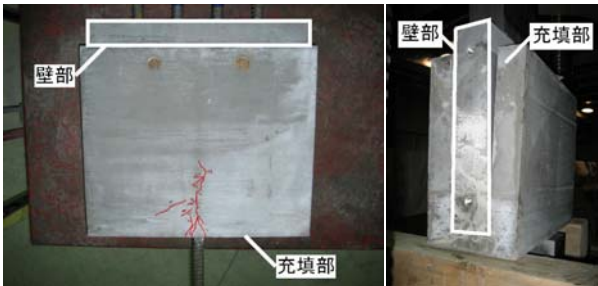
写真-3 B-T2破壊性状(左: B-T2-1 右: B-T2-2)
