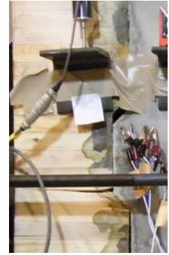
写真-5 破壊性状 (Bb-3-h180t30 左側シアキー集成材側面圧壊および集成材ラミナ貼り合わせ部分直近の分離ひび割れ)
