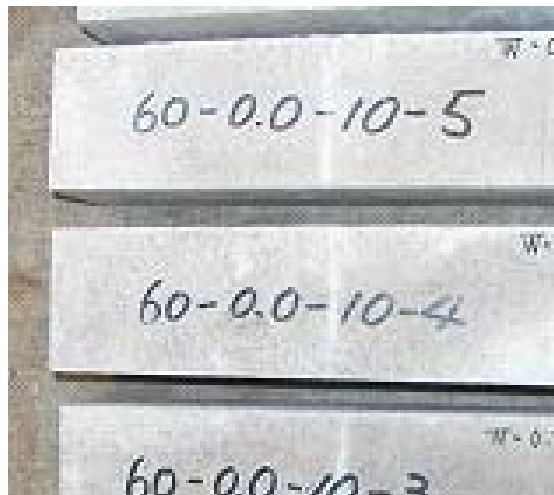
写真 - 5 促進腐食供試体
