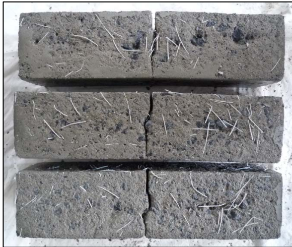
(a) 割裂状況 (側面) (C_crack : 300 サイクル)
