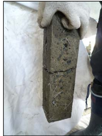
写真-2 C_crack 供試体 (300 サイクル)
