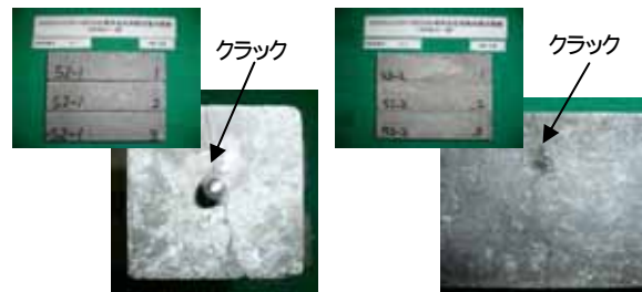
写真 - 1 モルタルバー試験状況 (左:S2-1, 右:S2-2)
