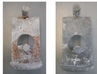
写真-5 発錆状況例 (円柱試験体)
