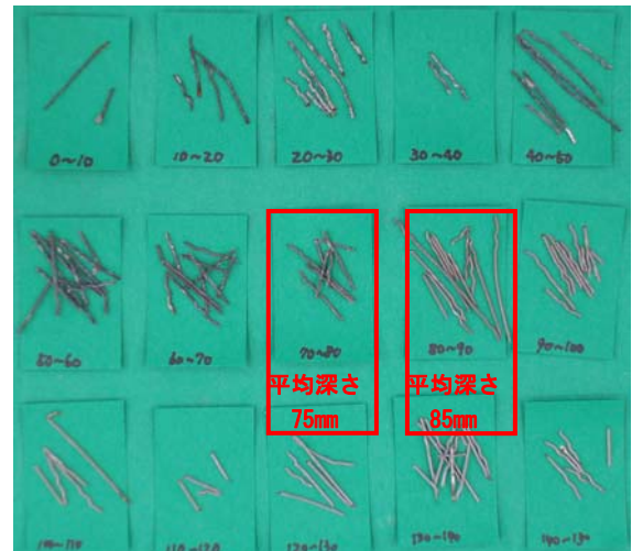
写真-5 加熱後のコアから取り出した鋼繊維
