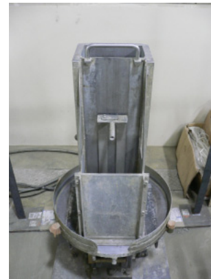
写真-1 振動台上に設置したボックス形充てん試験容器 (B室側から撮影)
